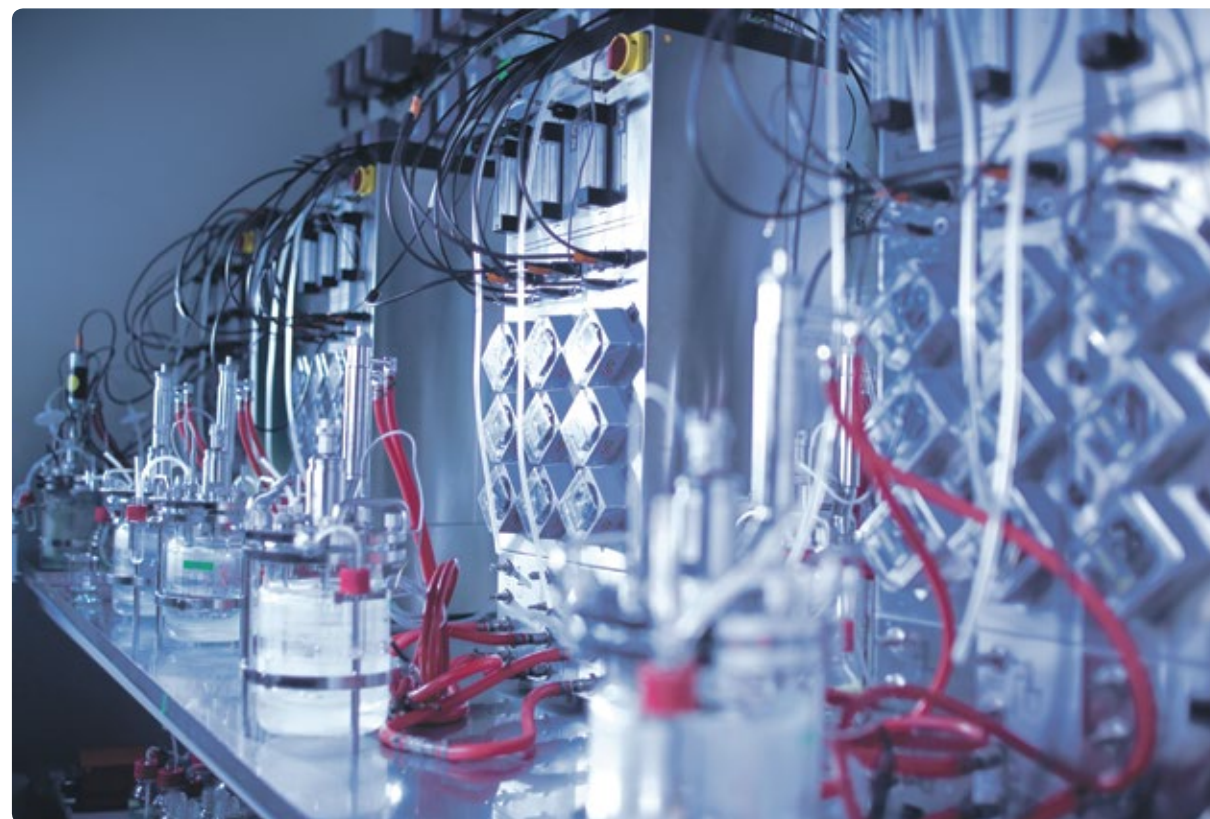
Um einen wirtschaftlichen Herstellungsprozess zu entwickeln, werden die optimalen Fermentationsbedingungen zunächst im Labormaßstab bestimmt.
